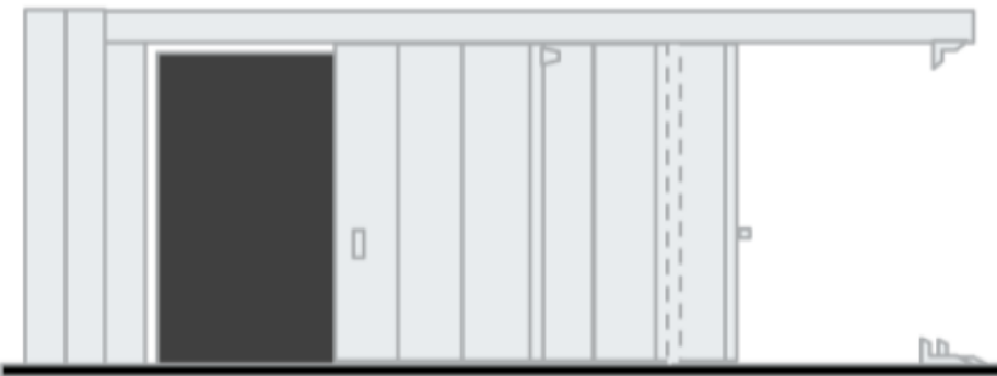
3. Teleskop – 2 / 3-teilig, rechts / links einlaufend
