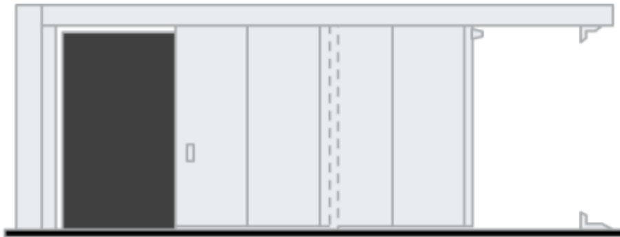
1. Einflügelig – rechts oder links einlaufend
