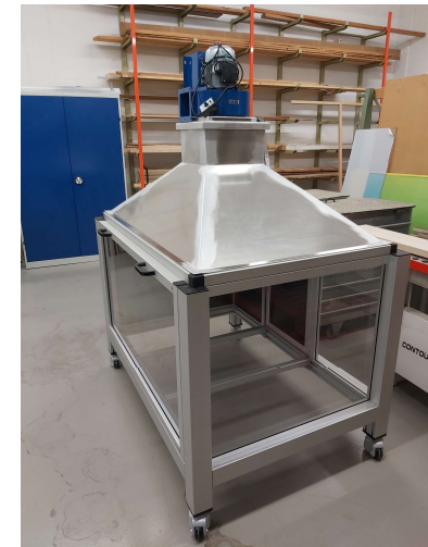
Dachkonstruktion mit Absaugung
